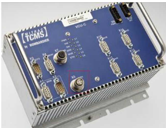
شکل ۱-۵-۱ نمونه‌ای تجهیزات TCMS همراه پورت Ethernet
