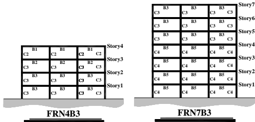
شکل ۳- جزئیات مدل‌های سازه‌ای مورد استفاده در فرآیند تحلیل بار افزون و NTHA
